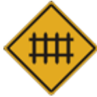
A-40 - Passagem de nível com barreira
