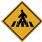
A-32 b - Passagem sinalizada de pedestres
