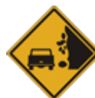
A-27 - Área com desmoronamento
